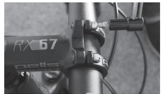
4. Richten Sie die Lenkstange so aus, dass Vorbau und Vorderrad auf einer Linie liegen (wenn sich der Vorbau nicht drehen lässt, lösen Sie die beiden Schrauben an der Seite des Vorbaus leicht). Am besten richten Sie den Vorbau aus, indem Sie sich über den Rahmen stellen, das Vorderrad zwischen den Knien halten und den Vorbau mit beiden Händen zentrieren. Ziehen Sie die seitlichen Schrauben des Vorbaus mit dem empfohlenen Drehmoment an.
