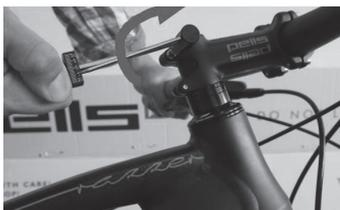
5. Teraz skontrolujte správne nastavenie hlavového zloženia (riadenie). Spoznáte ho jednoducho: riadidlá sa musia otáčať ľahko a plynulo a zároveň riadenie nesmie mať vôľu. Tú spoznáte tak, že sa postavíte nad rám, ľavou rukou stlačíte prednú brzdú, pravou rukou objímte hornú miskú hlavového zloženia a pohybami dopredu-dozadu pravou rukou necítite vôľu (vidlica v hlavovom zložení neklope, nie je voľná).
