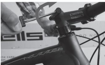
5. Nyní zkontrolujte správné seřízení hlavového složení (řízení). Poznáte ho jednoduše: řídítka se musejí otáčet lehce a plynule a zároveň řízení nesmí mít vůli. Tu poznáte tak, že stoupnete nad rám, levou rukou zmáčknete přední brzdu, pravou rukou obejměte horní miskou hlavového složení a pohyby dopředu-dozadu pravou rukou necítíte vůli (vidlice v hlavovém složení neklepe, není volná).
