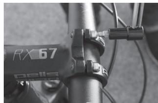
4. Ustaw kierownicę tak, aby mostek i przednie koło znajdowały się w jednej linii (jeśli mostka nie można obrócić, lekko połuzuj dwie śruby z boku mostka). Najlepszym sposobem na wyrównanie mostka jest pozycja nad ramą, przytrzymanie przedniego koła kolanami i wysródkowanie mostka obiema rękami.
